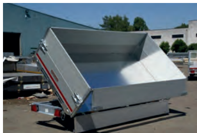
Fig. Sidevægge med tophængsel
